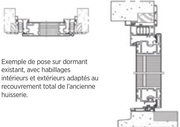
Exemple de pose sur dormant existant, avec habillages intérieurs et extérieurs adaptés au recouvrement total de l'ancienne huisserie.
